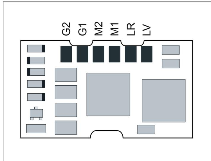
Der **Fahrzeugdecoder für Miniaturmotoren DH06A** ist als direkter Ersatz des werkseitig verbauten Decoders der Spur N Köf aus dem Hause Minitrix vorgesehen. Durch den Einsatz modernster Schaltreglertechnologie wird die für den Spezialmotor erforderliche Betriebsspannung von 6 Volt nahezu verlustfrei durch den Decoder selbst hergestellt. Durch den Einsatz unseres Super-Soft-Drive-Verfahrens zur Motoransteuerung und -regelung entsprechen nun die Fahreigenschaften denen unserer übrigen Decoder.
