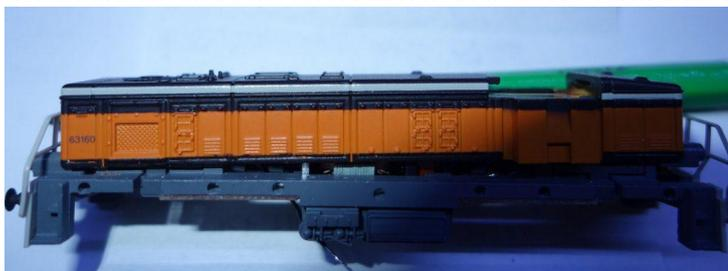
U) Appuyer fortement la caisse sur le châssis tout en la faisant coulisser vers l'arrière. Elle se trouve alors verrouillée et ne doit pas sortir si vous la tirez vers le haut. Si vous ne parvenez pas à faire coulisser la caisse, c'est soit qu'elle ne descend pas en butée sur le châssis, soit qu'un élément gêne son déplacement. Voir en fin de document SVP.
