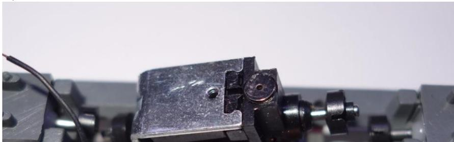
H) Remettre en place le moteur en prenant garde à ce que la limande ne se replie pas, côté opposé au fil gris.
